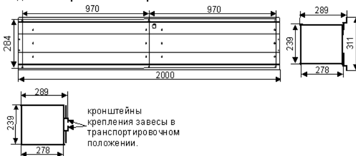
Вид ЗВТ18 с кронштейнами в рабочем положении.
